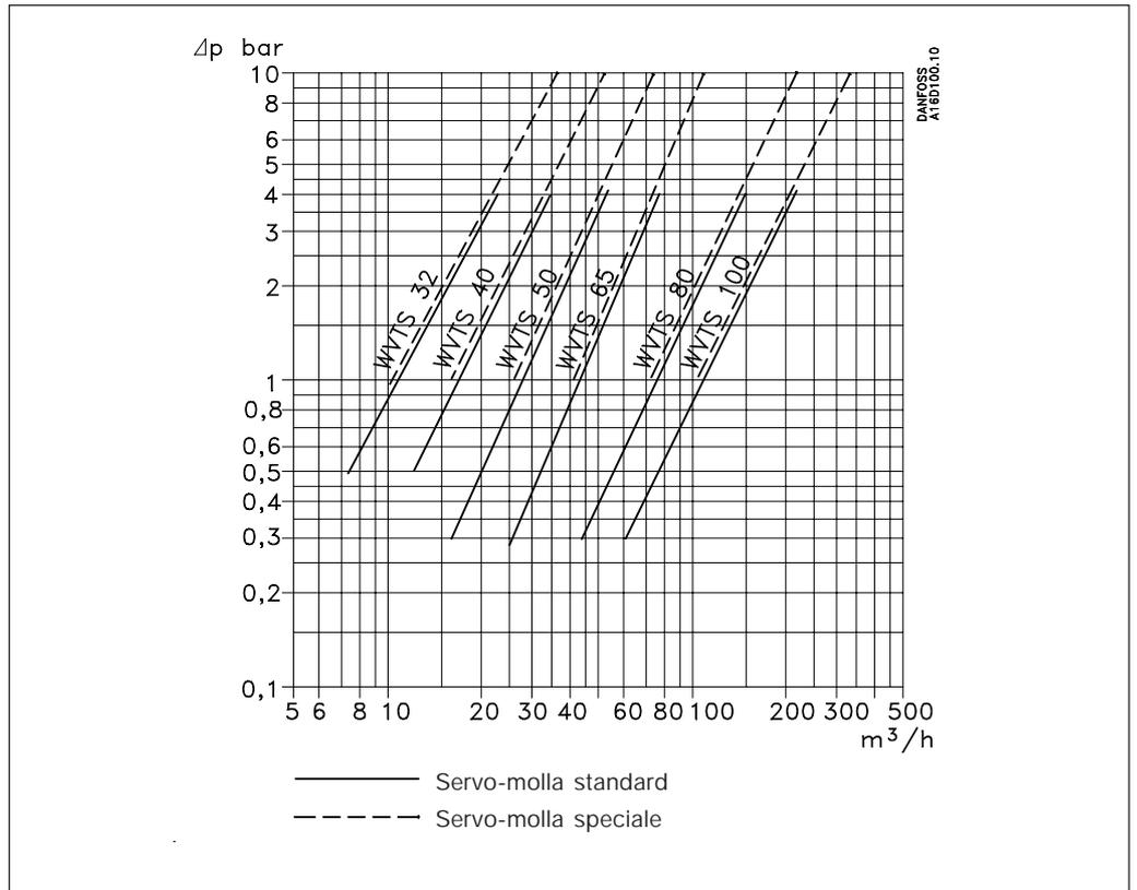
Le curve di capacità mostrano la capacità (quantità d'acqua in m<sup>3</sup>/h) delle singole valvole come una funzione di caduta della pressione all'interno della valvola.
