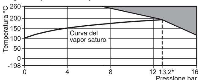
**Nota:** le condizioni di utilizzo si riferiscono a versioni con tenuta metallica (standard); con tenute soffici sono limitate dalla scelta del materiale di tenuta (viton o EPDM).
