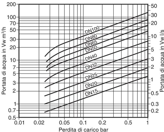
Le curve del grafico sono riferite a portate di acqua a 20°C; per determinare le perdite di carico per fluidi diversi, occorre calcolare, utilizzando la formula sottostante, la portata d'acqua equivalente ed utilizzarla inserendola nel grafico.
