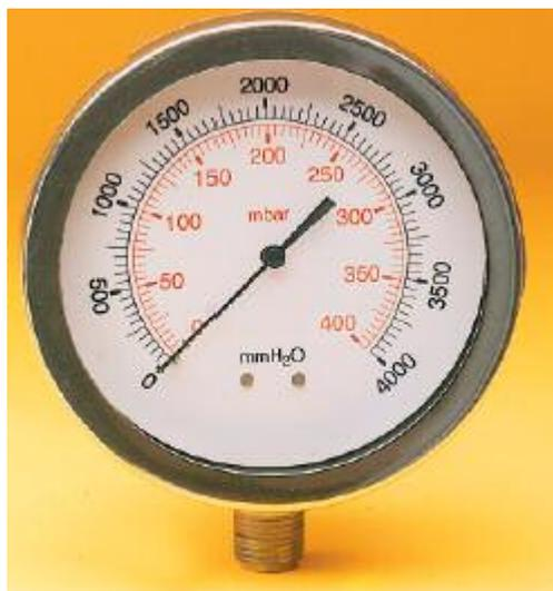
Manometri industriali con elemento elastico a capsula. Strumenti realizzati per misurare bassissime pressioni, particolarmente fluidi gassosi. Temperatura d'esercizio da -25/+75°C.
