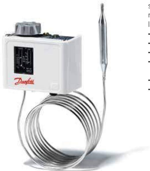
I termostati KP Danfoss si utilizzano per il controllo, il monitoraggio nei sistemi di allarme nell'industria. La gamma KP consiste termostati muniti di un commutatore monopolare (SPDT) e sono in grado di controllare direttamente motori c.a. monofase fino a 2 kW.
