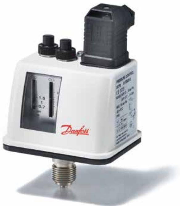
Il tipo BCP è una serie di pressostati per applicazioni di sicurezza e monitoraggio della pressione nelle caldaie a vapore e ad acqua surriscaldata. Il BCP incorpora un microinterruttore a commutazione unipolare in cui la posizione del contatto dipende dalla pressione nell'attacco e dal valore del campo impostato. Per applicazioni in cui il funzionamento è un elemento critico per la sicurezza, si consiglia l'utilizzo di un pressostato intrinsecamente sicuro.
