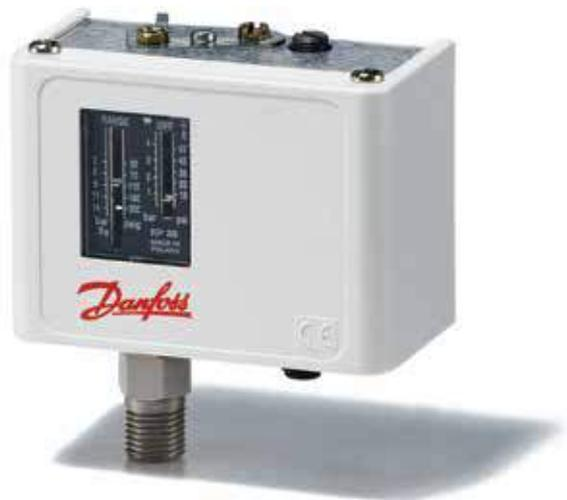
I pressostati Danfoss KP si utilizzano nei sistemi di controllo, di monitoraggio e di allarme in applicazioni industriali. La serie KP è adatta a mezzi gassosi ed aria. Questi pressostati sono muniti di un commutatore monopolare (SPDT) e possono controllare direttamente motori a corrente alternata monofase fino a 2 kW.
