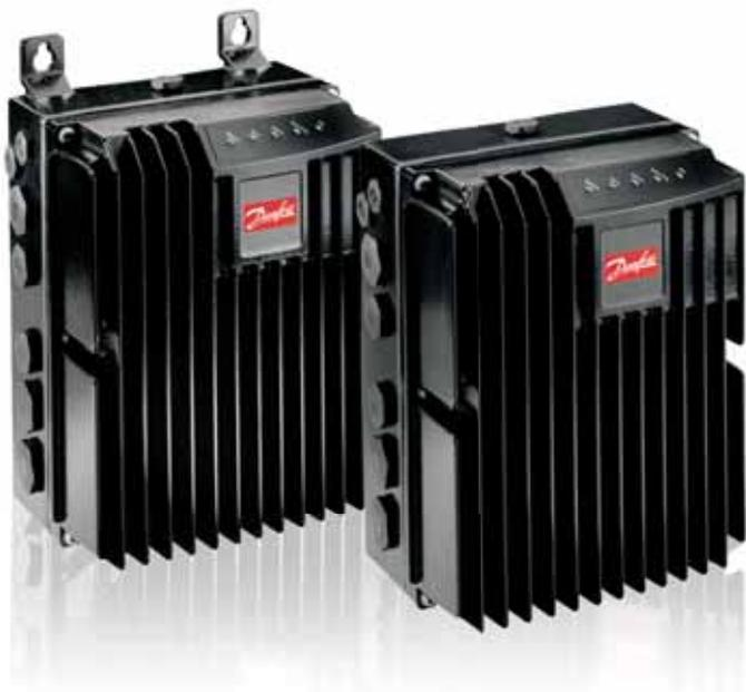
Il VLT® Decentral FCD 300 è un convertitore di frequenza completo progettato per il montaggio decentralizzato. Può essere montato sulla macchina, a parete in prossimità del motore oppure direttamente sul motore.
