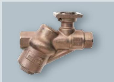
Le valvole di regolazione caratterizzate indipendenti dalla pressione per una portata costante da 0.09 a 5.05 l/s, combinano le funzioni di bilanciamento, intercettazione e di regolazione in un unico corpo valvola.
