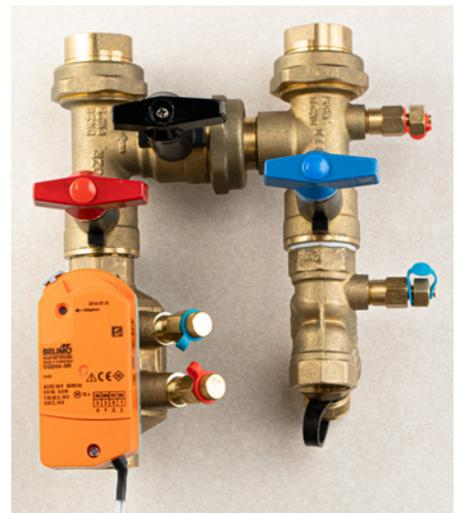
Assemblaggio in configurazione H per fan coil. Il bypass permette il lavaggio della tubazione senza danneggiare lo scambiatore di calore. Dotato anche di PIQCV sul ritorno per compensare le fluttuazioni di pressione. La portata può essere misurata tramite un orificio del misuratore di portata.
