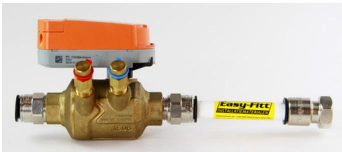
Per la ristrutturazione/modernizzazione degli edifici i componenti devono essere installati in tubazioni esistenti. Le dimensioni sono quindi specificate da quest'ultime. Nella PIQCV di cui sopra, questo è stato risolto utilizzando una parte tubolare facilmente accorciabile. L'assemblaggio è montato e testato da Belimo e può essere regolato in loco alla lunghezza richiesta.
