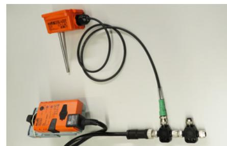
Collegamenti con lunghezza del cavo adattata e spine del connettore Phoenix. Il sensore di temperatura a canale/a immersione e l'attuatore per valvole sono combinati in un'unica spina del connettore.
