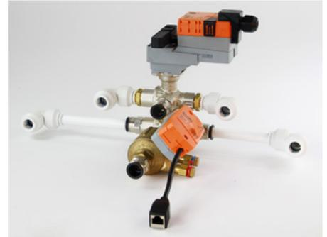
Valvola di regolazione a sfera a 6 vie combinata con una PIQCV per formare una valvola a 6 vie indipendente dalla pressione con tubazione di facile montaggio e attacchi rapidi. Dotata di una presa del connettore RJ45 per comunicare con il sistema di gestione dell'edificio.
