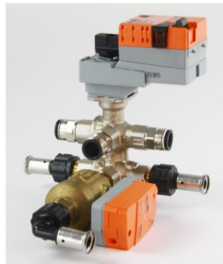
Assemblaggio indipendente dalla pressione per soffitti a travi fredde/calde composto da una valvola di regolazione a sfera a 6 vie e una PIQCV. Dotato di connettori a pressione e attacchi rapidi.
